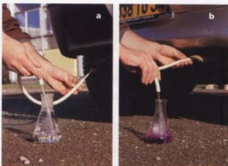
14 Les gaz d'échappement d'une voiture à essence barbotent dans une solution violette de permanganate de potassium\* acidifiée (a. sans pot catalytique; b. avec pot catalytique).
